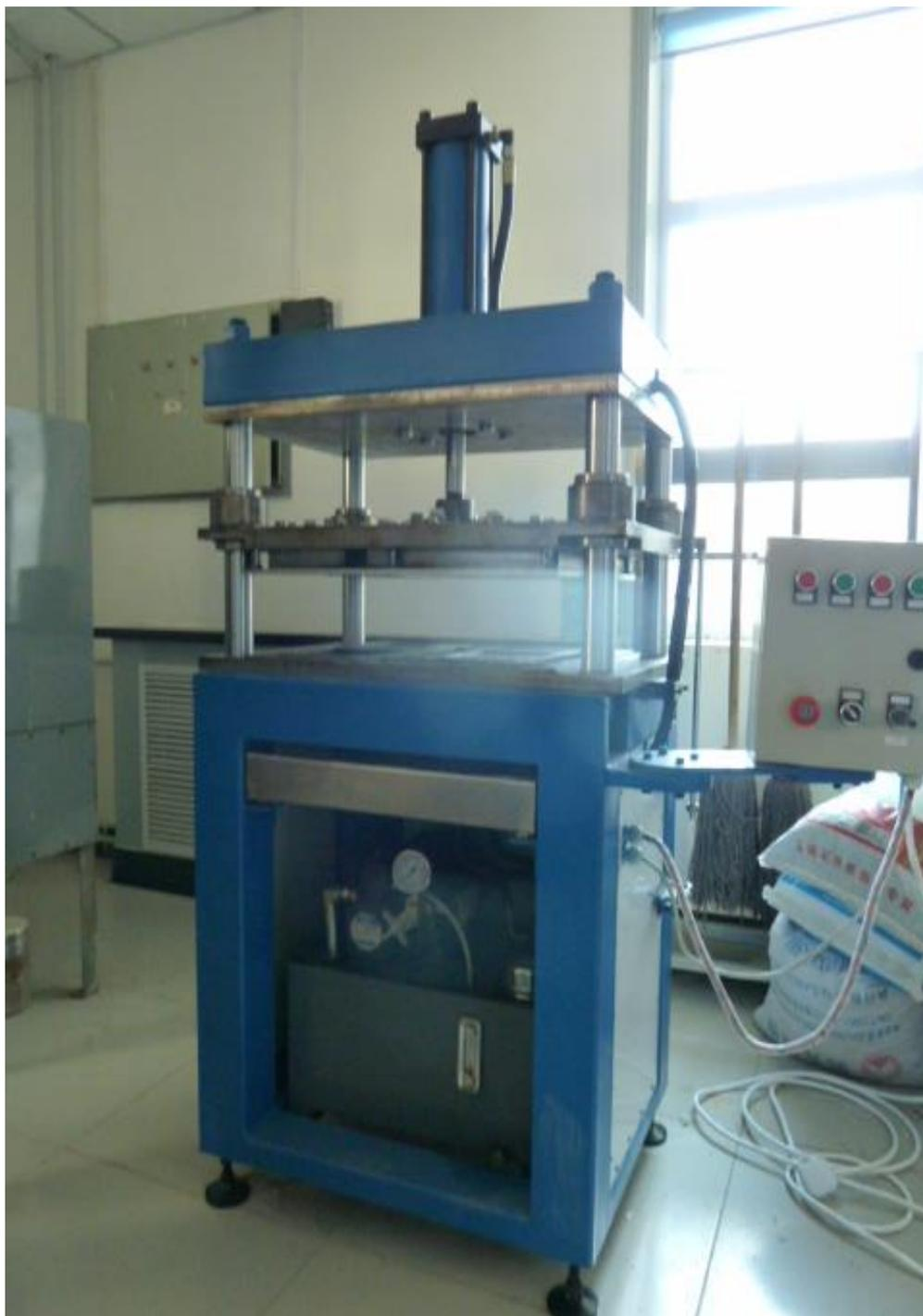
简介：沥青防水卷材标准试件自动冲压机是我院根据 GB18242-2008 标准研制，精度±0.1mm，冲压出的试件尺寸完全符合标准中 6.6 表 3 所规定，该设备可大幅提高工作效率和尺寸精度，是中大型防水卷材生产企业和防水检测单位的必备工具。
